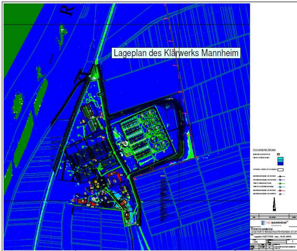
Abb: Überflutung des Klärwerks Mannheim bei HQextrem, Quelle: Anlage 16 der Antragsunterlagen
