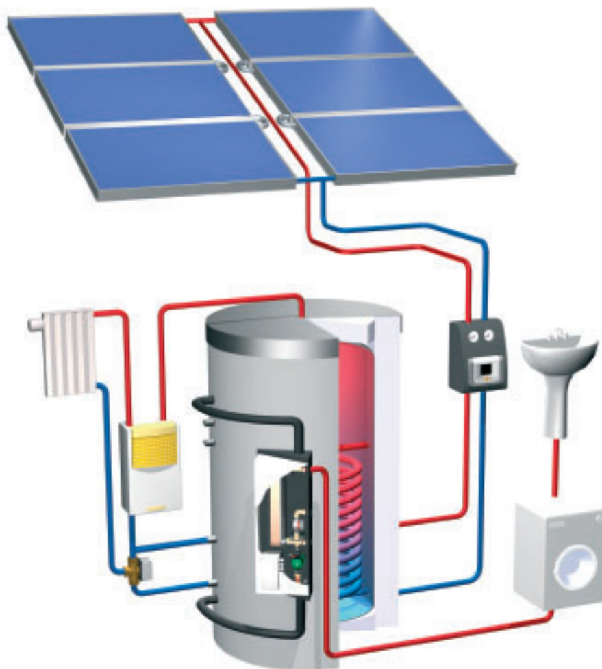
Schema einer Solarthermieanlage
