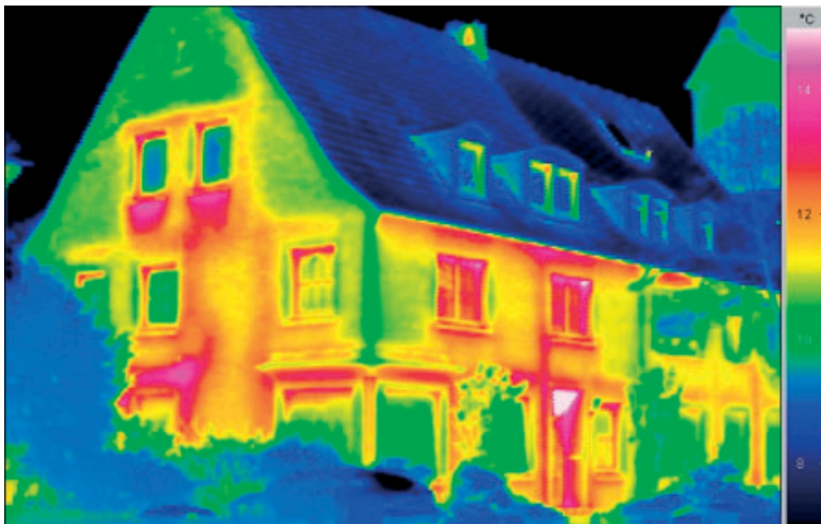
Thermografieaufnahme eines Wohnhauses
