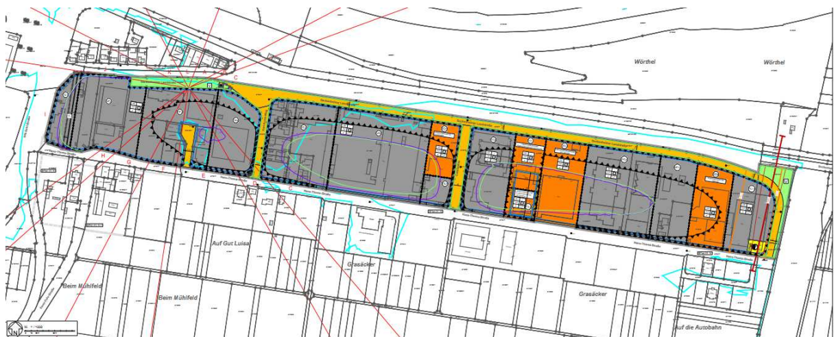
Abbildung: Planzeichnung zum B-Plan, u.a. mit Festsetzung von Flächen als Gewerbegebiet, Sondergebiet (orange), Verkehrsflächen (hell-orange) und Flächen für Verkehrsgrün (grün).
