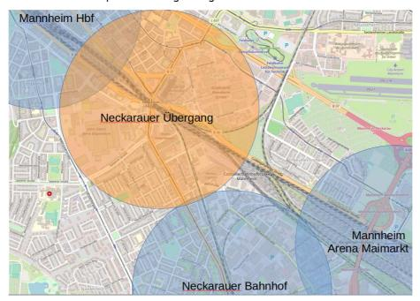
Der gesamte Bahnknoten Mannheim Hbf. wird einer Überprüfung der Leistungsfähigkeit im Rahmen der Schnellfahrstrecke Mannheim Karlsruhe unterzogen. In diesem Zuge werden wahrscheinlich Maßnahmen entworfen, die die Gleisanlagen insbesondere auf der östlichen Bahnhofseinfahrt wesentlich verändern.
